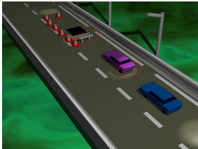
FIG. 1.1: Situation routière typique que le système doit analyser : le véhicule bleu doit détecter l'arrière du véhicule violet et le véhicule violet doit détecter la signalisation en travaux (l'image a été réalisée avec POV[oVR] 1 )
